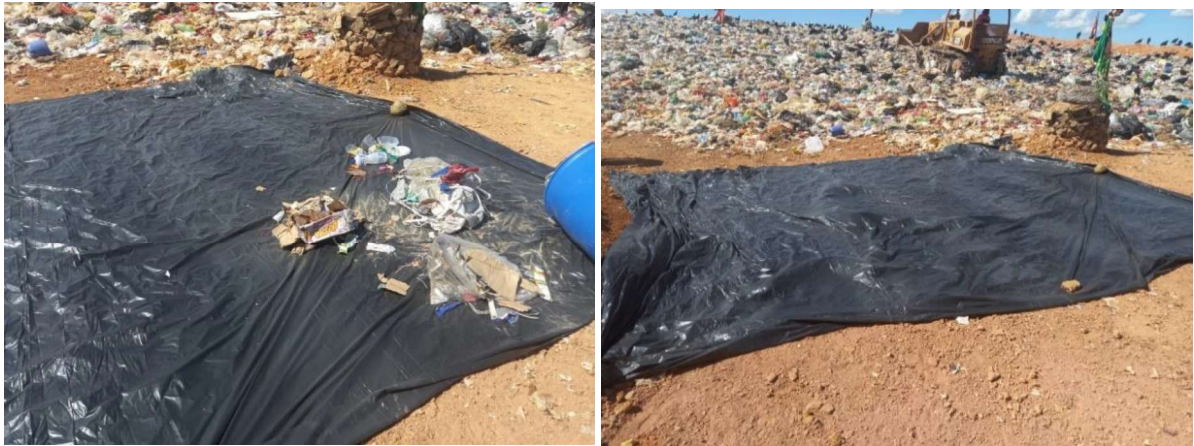
Figura 91 – Separação de Resíduos por Categoria na Lona Plástica para Estudo de Caracterização
