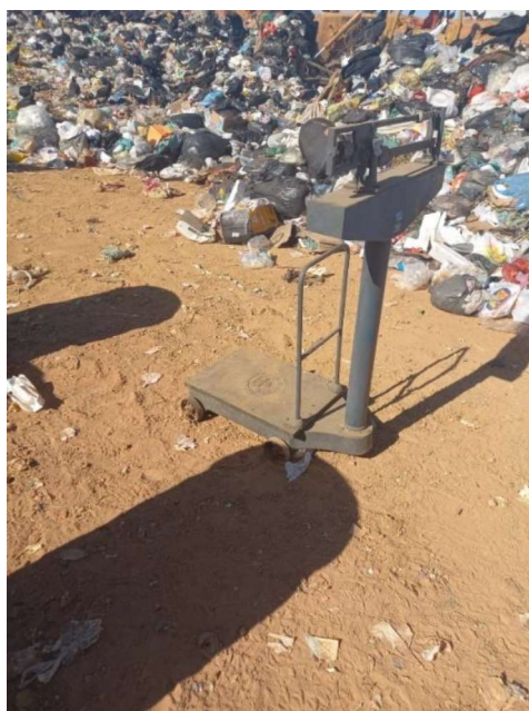
Figura 89 – Balança Utilizada para as Pesagens de Resíduos
