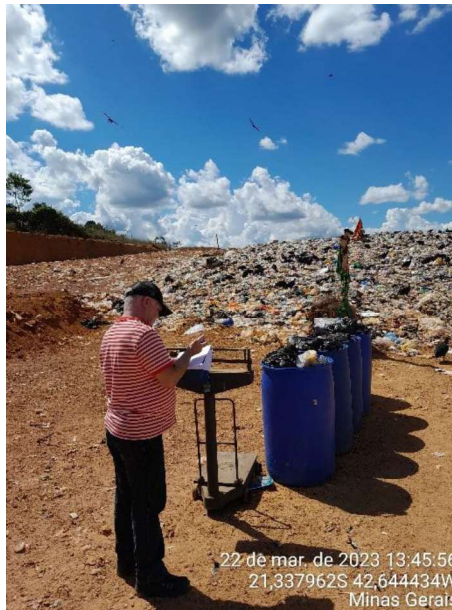
Figura 85 – Profissional Realizando a Análise Gravimétrica dos Resíduos Gerados
