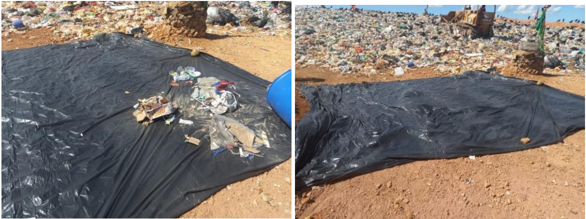
Figura 113 – Separação de Resíduos por Categoria na Lona Plástica para Estudo de Caracterização
